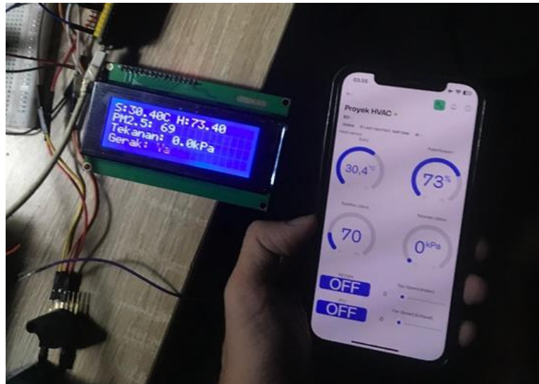
Gambar 3. Tampilan LCD 20x4 dan Dashboard Blynk Saat Sistem Berjalan
